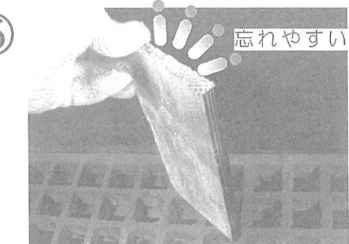
片面が焼けたら、一度ガスバーナーの火を消してから、軍手をしている方の手で板を裏返し、残りの部分を焼きます※側面の焼き忘れに注意してね
